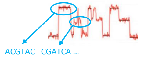
Fig 7 : Phase de basecalling du MinION [6].
